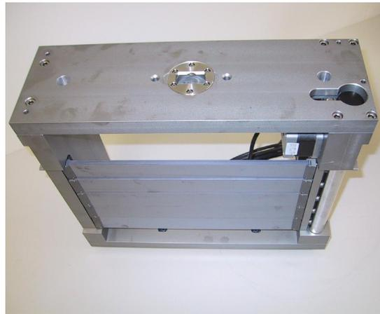
(b) Si-Monochromator. Zur Fokussierung werden die Waver direkt gebogen.
