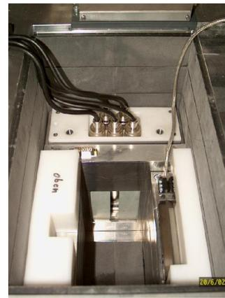
(e) Detektor bestehend aus 5  $^3\text{He}$ -Zählrohren
