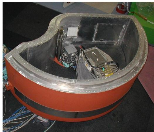
(g) Blick in das Sekundärspektrometer (ohne Kristall). Der Detektor befindet sich unter der grauen Abschirmung
