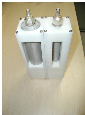
(f) Detektorzählrohre vor dem Einbau in die Detektorabschirmung
