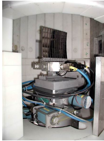
(b) PG-Analysator in der seitlich geöffneten Abschirmung. Durch Drehung der Segmente wird die horizontale Krümmung variiert.
