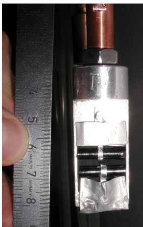
(e) Typische Probenmontage für den Einbau in einen Kryostaten
