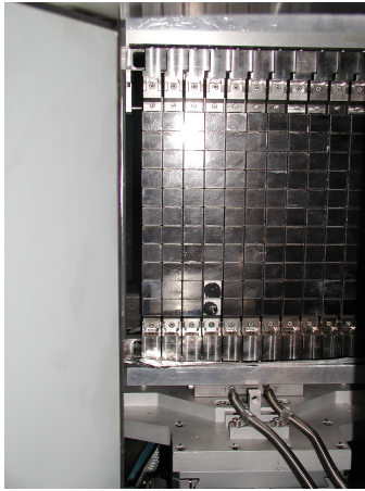
(a) Blick in die seitlich geöffnete Monochromatorabschirmung auf den PG-Monochromator.
