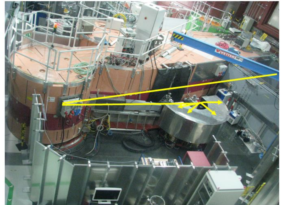
Pulverdiffraktometer SPODI am FRM II
